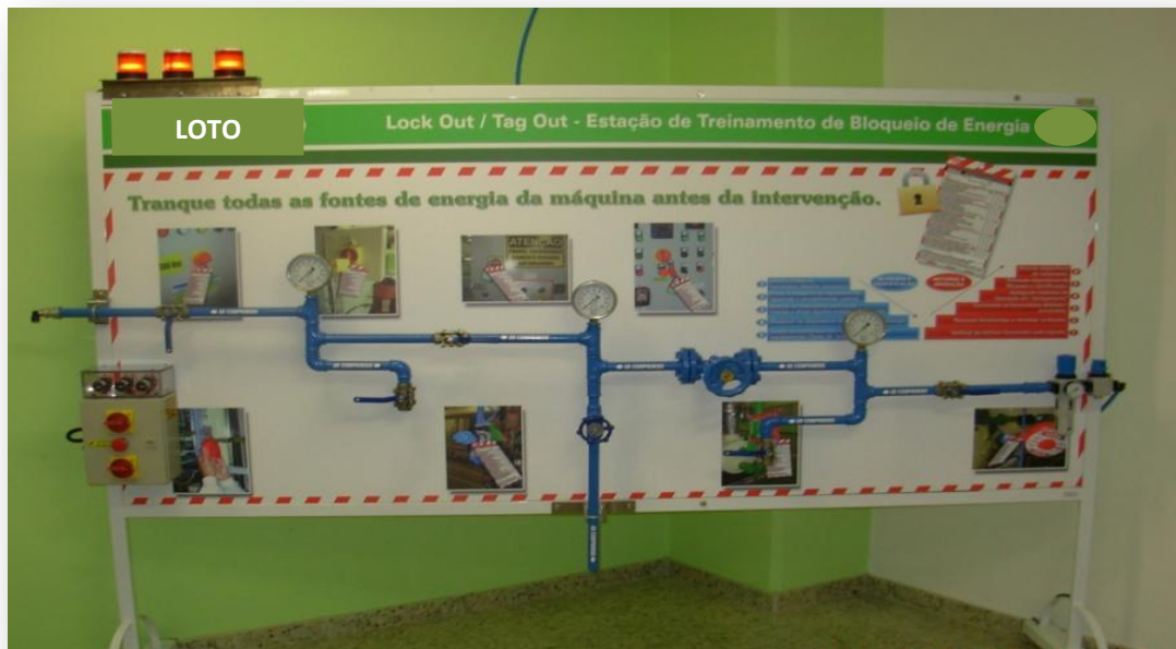
Figura 26 - Estação para Treinamento de LOTO Fonte: Arquivo pessoal, 2014
