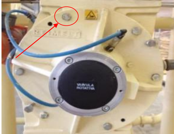
Figura 11 - Detalhe Parafuso que Demanda Ferramenta Especial Fonte: Arquivo pessoal, 2014
