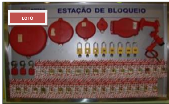
Figura 22 - Estação de Bloqueio de LOTO Fonte: Arquivo pessoal, 2014
